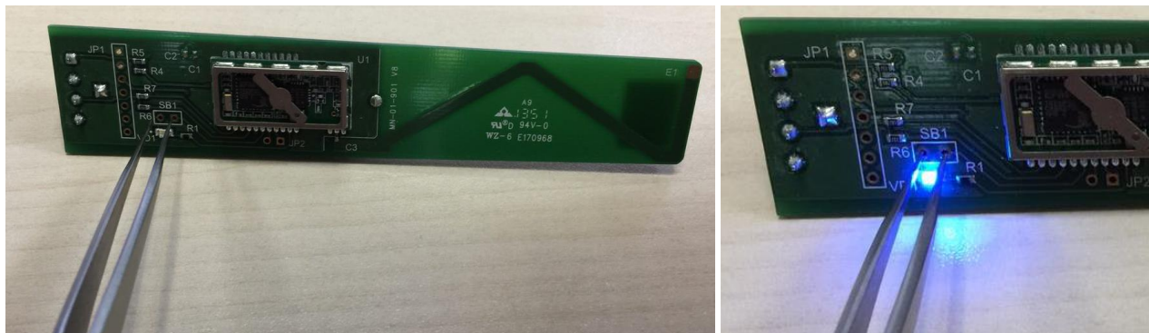
Контакты для замыкания для калибровки модема
